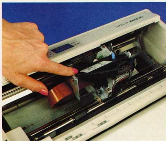
Der Druckkopf des Brother. Der schwere, gußeiserne Rahmen wirkt sehr robust.
